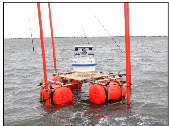
写真⑪ 追い払い装置設置状況
