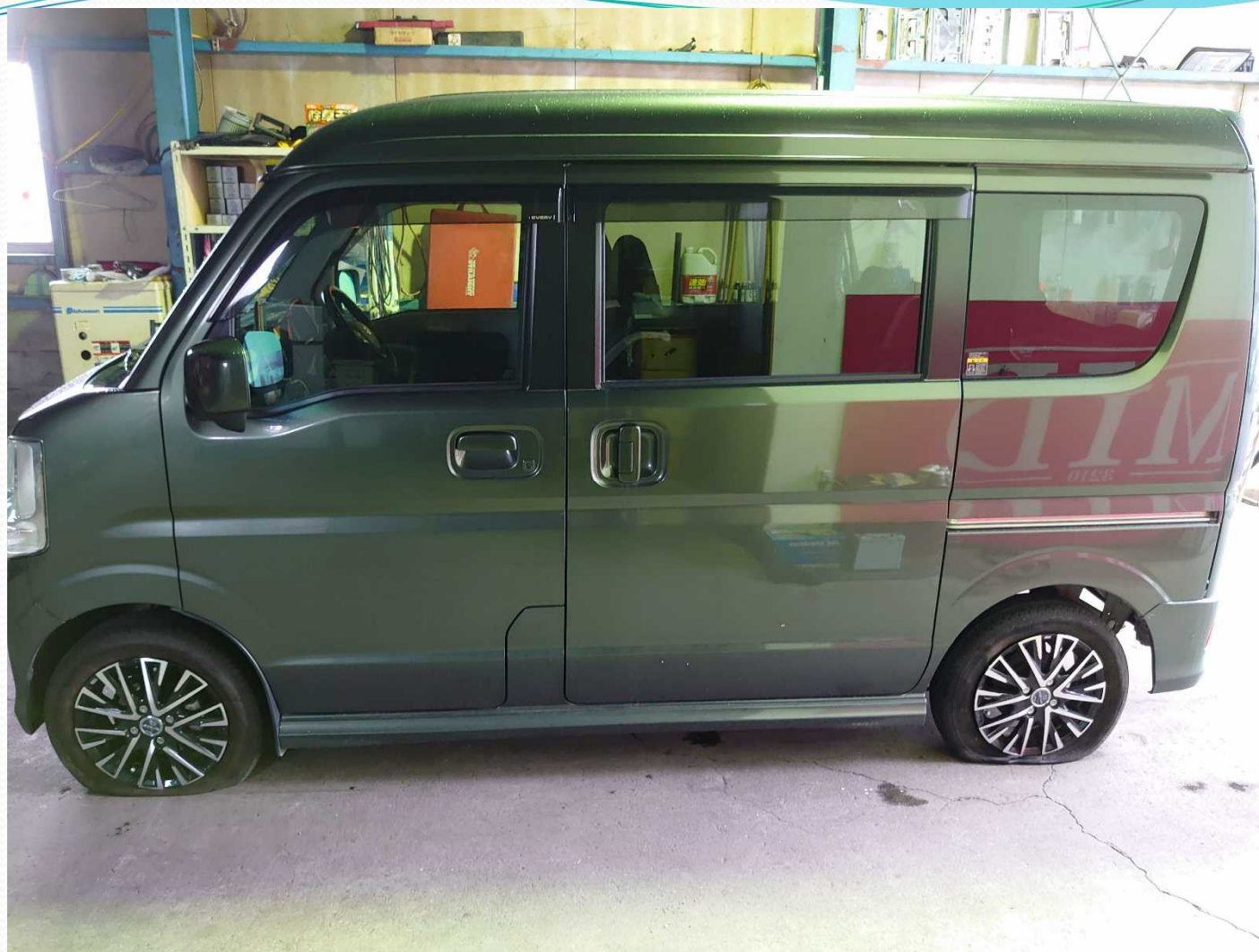
当事車両の損傷状況(左前後輪損傷)
