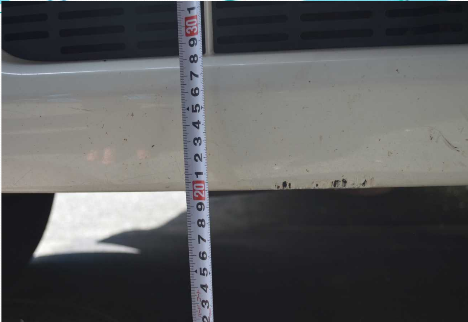
当事車両の損傷状況（前部バンパー）
