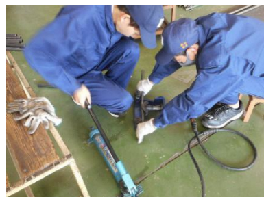
パイプ曲げ作業
