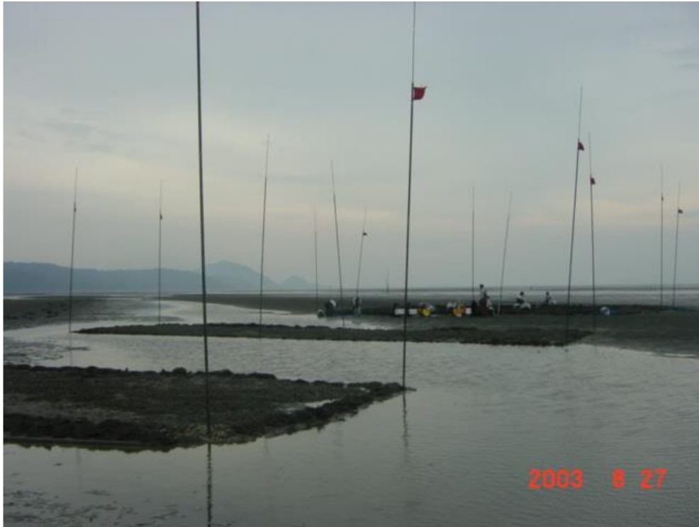
図56 砕石を用いた試験漁場(平成14年 有明海網田地先)
