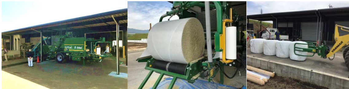
マルチコンパクター (Orkel 社) による梱包作業 運搬・保管 図1 マルチコンパクターを用いた粳米サイレージ製造体系の様子
