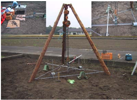
写真3 垂直・水平耐力試験装置
