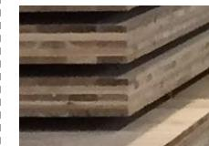
\*CLT：直交集成板。ひき板を繊維方向が直交するように積層接着した木材製品。
