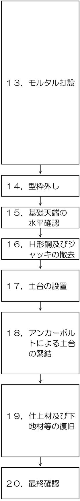
①基準点のレベルを基礎天端において計測器で示し、沈下の少ない基礎天端を基準にレベル調整用モルタルを打設する。自然に放置することでレベル調整用モルタルは水平になる。
