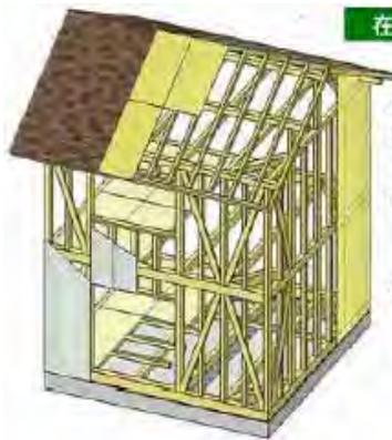
**在来工法(木造軸組み工法)**
