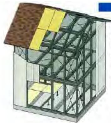
**鉄骨ブレース工法**
