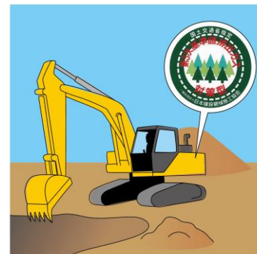
排出ガス対策型建設機械の採用イメージ
