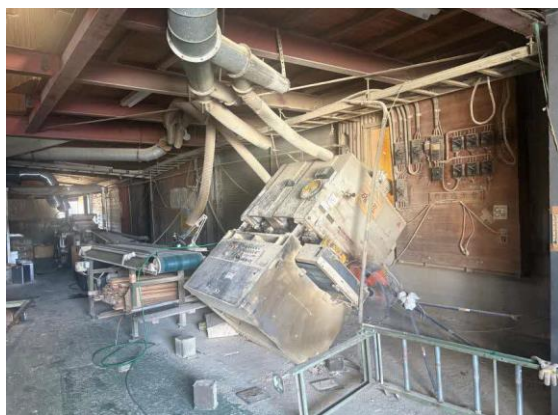
材木店機械類の転倒
