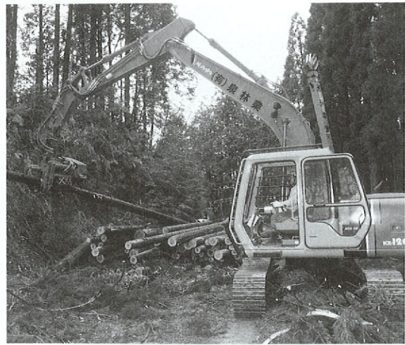
ボタンひとつで伐倒から玉切りまで行うプロセッサ―
