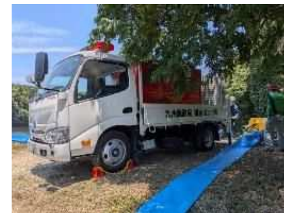
排水ポンプ車（農林水産省）による 水位低下を支援
