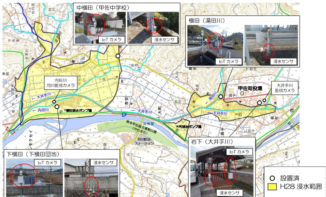
図 12-7 甲佐町 浸水センサ設置状況
