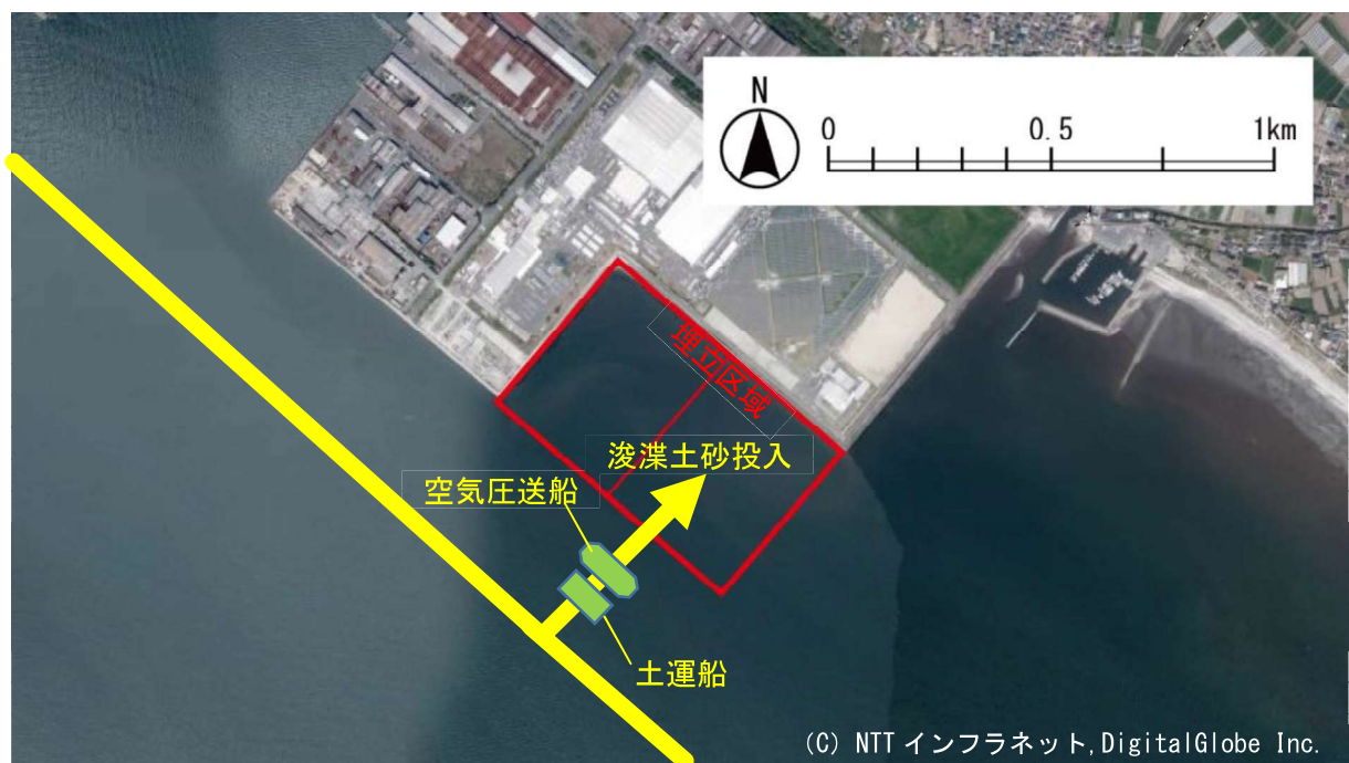
【2期工事完了後】
