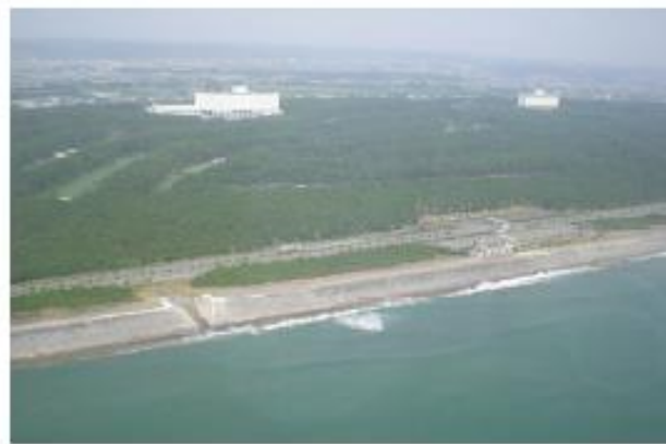
●潮害防備保安林 樹幹によって波のエネルギーを弱めるほか、林冠によって海水微粒子を捕捉して塩害を防止
