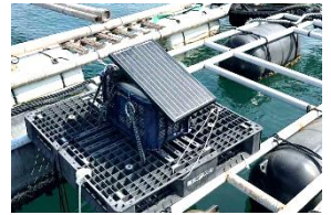
自動水質観測浮遊機 (楠浦湾)
