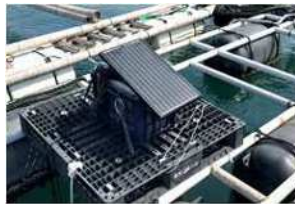
自動水質観測浮体（楠浦湾）
