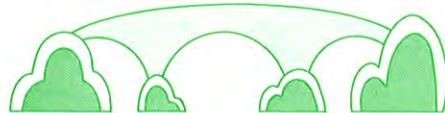
中の橋(3号橋) 永浦島-大池島を結ぶコンクリート橋で、型式はスパン中央にヒンジを有するラーメン橋。長さは362m、高さ15m。
