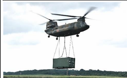
CH-47による機外懸吊
