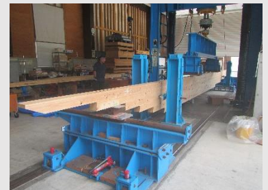
③実大木質材料万能試験装置
