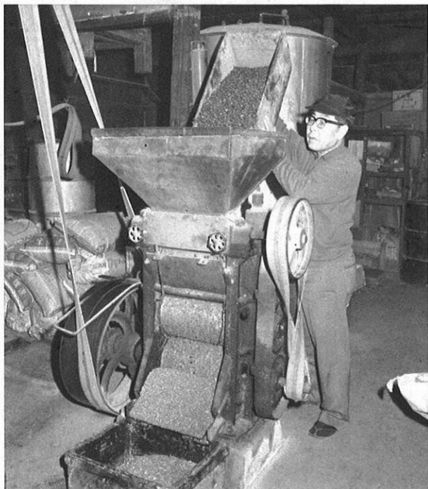
▼椿の実を十分に乾燥させたあと、機械にかけて小さく砕く。
