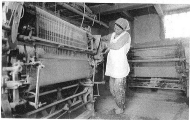
▼最後に製織機にかけられ「肥後表」が誕生する。
