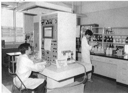
▲有機物質・石油などの分析をするガスクロマトグラフ。
