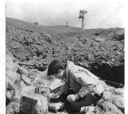
▲ 山上一帯に装置されている小型地震計。このデータが山上の観測所へ送られる。
