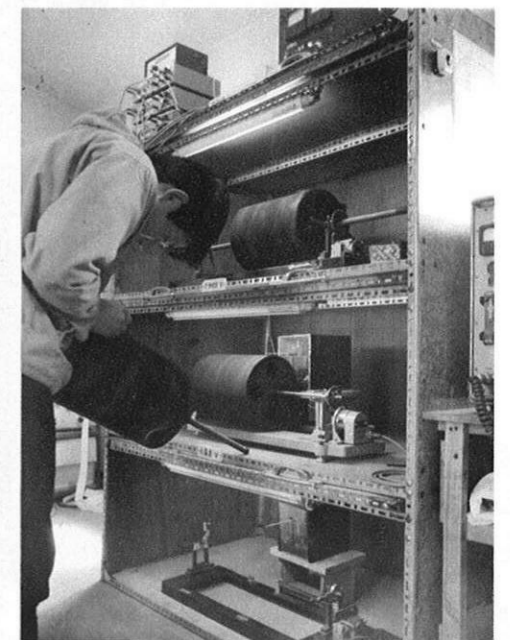
▲ 各地震計から送られてくるデータが山上の本堂観測所で集中的に記録される。
