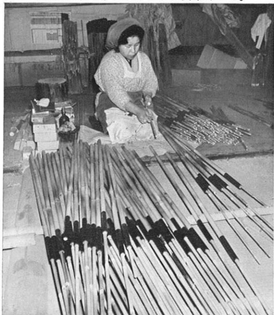
下・継ぎざおは、最後の仕上げとしてサウンドペーパーで肌をみがき、ニスをぬれば出来あがり。
