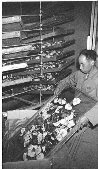
上・生しいたけの乾燥—温度を決めれば自動的に調節される。
