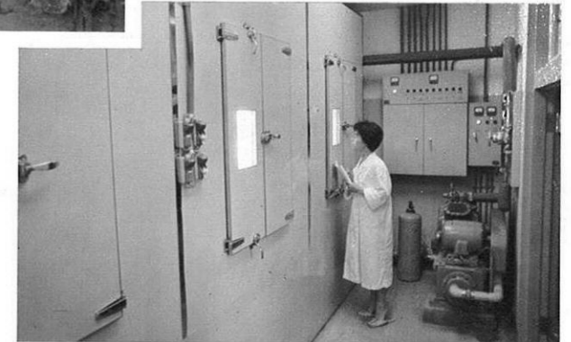
上・人工気象室—人工的に太陽光線が出せる新しい装置で、桑のイシユク病対策で活用される。
