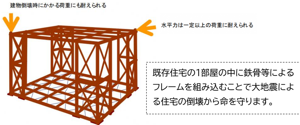
図 4.6.8 耐震シェルターの一例 (住宅における地震被害軽減に関する指針・同解説(案)より:内閣府)
