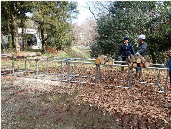
写真－２ 単管パイプを用いた作業台
