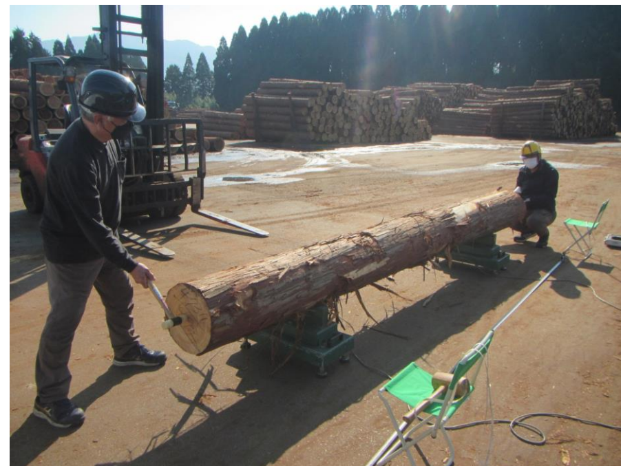
丸太の固有振動数測定状況
