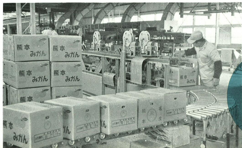
選果も機械化されて商品価値を高めている 写真は日本には3台しかない天水町のオートメーション大型選果機
