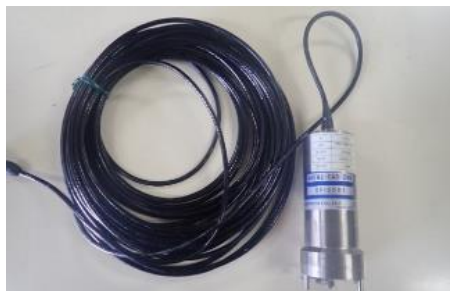
図1 有害プランクトンセンサー
