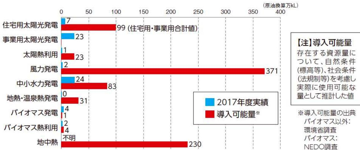
図 4 - 2 県内の再生可能エネルギー導入可能量と導入実績の比較
