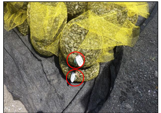
図2 温度計測データロガー設置状況
