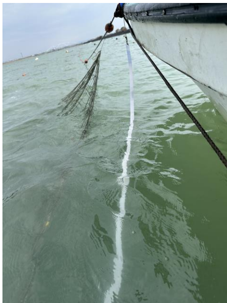
図5 ギョニゲール (ステンレス製反射板)
