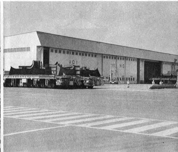
▼前後左右自在に移動する運搬車
