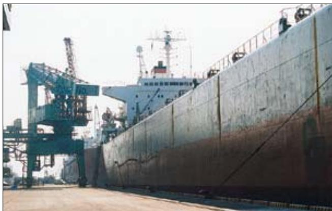
12) 喫水：船舶の水面より水中に沈む船体の深さ。喫水は積んでいる貨物量の増減によって変化します。
