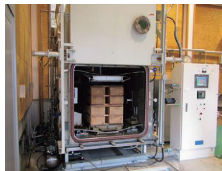
写真2 高周波減圧乾燥機
