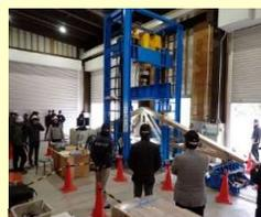
依頼試験（木造屋根トラス曲げ試験）
