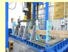
②枠組壁工法スギ強度試験
