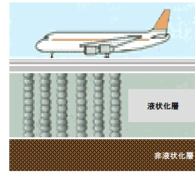
液状化層の地盤改良対策により、舗装の損壊を防止
