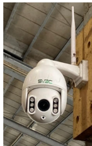
カメラ（可動式） ※左右上下の移動が スマートフォンから 可能
