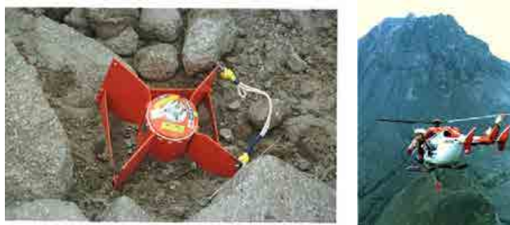
図 5-16 九州大学などが雲仙普賢岳へ投下したペネトレータ (九州大学ホームページより引用) ( http://www.sevo.kyushu-u.ac.jp/sevo/staff/shimizu/peneto.html )
