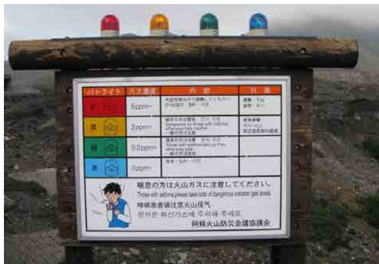
図 2-4 中岳火口周辺に設置されている火山ガス規制のパトライト
