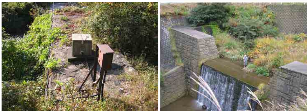
図 5-17 阿蘇山で設置されている振動センサ（左），ワイヤーセンサ（右）
