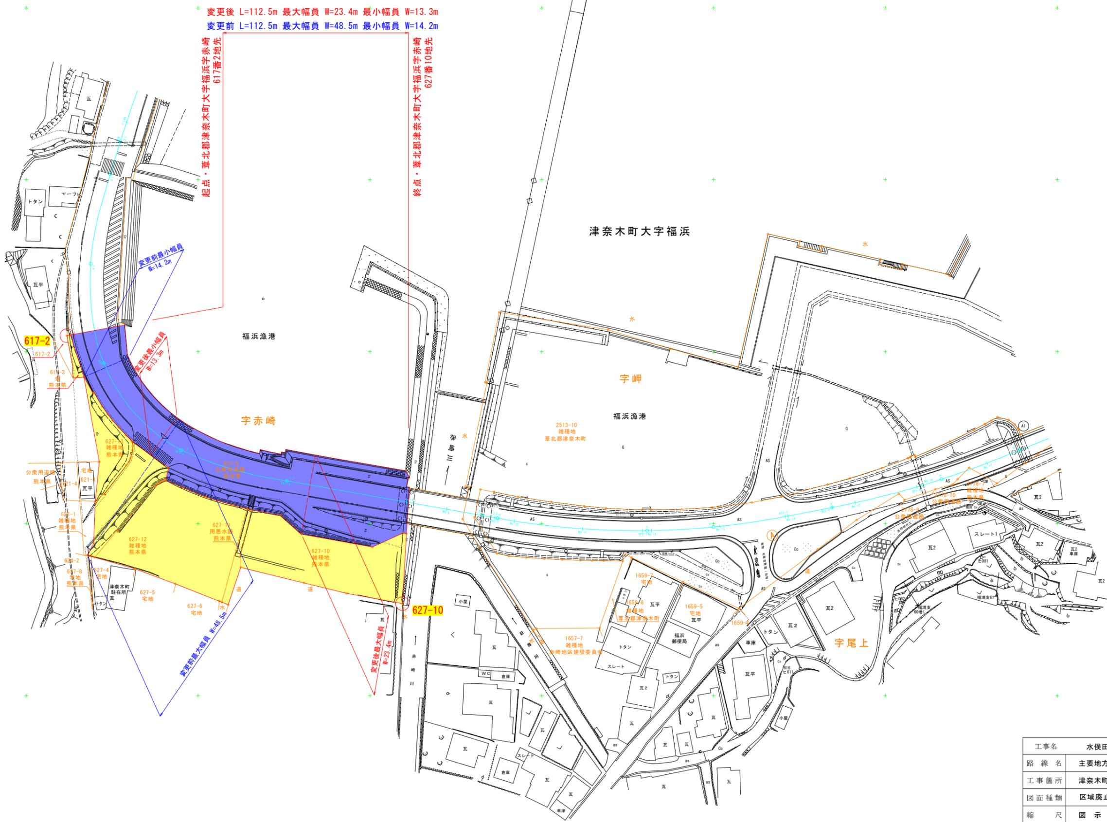
変更後 L=112.5m 最大幅員 W=23.4m 最小幅員 W=13.3m
