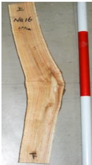
a. 枝打ち施業をしたセンダンの断面 幹曲がりの矯正が遅れるだけでなく、枝打ち痕が目立つ、変色するなどの欠点になりやすい
