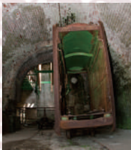
Headframe cage (Elevator cage) 竖坑槽ケージ
