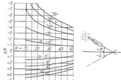
本表は、土木学会「硬化コンクリートのテストハンマー強度の試験方法(JSC-E-G 504)」中の、日本材料学会の強度推定式で用いる角度補正図(左図:)を数値化し、早見表として整理したもので
