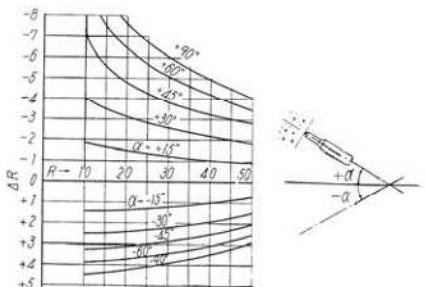
本表は、土木学会「硬化コンクリートのテストハンマー強度の試験方法(JSC-E-G 504)」中の、日本材料学会の強度推定式で用いる角度補正図(左図:)を数値化し、早見表として整理したものです。
