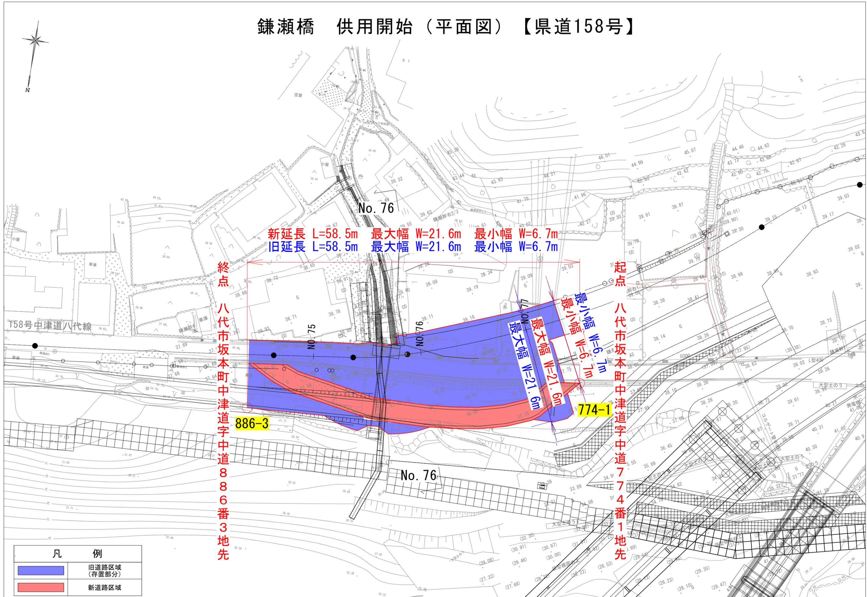
新延長 L=58.5m 最大幅 W=21.6m 最小幅 W=6.7m
