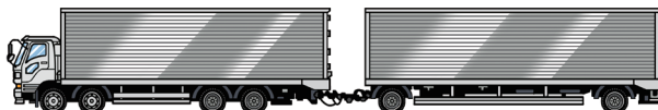
特車許可基準の車両長を緩和 (施行前の21mから最大で25mへの緩和)
