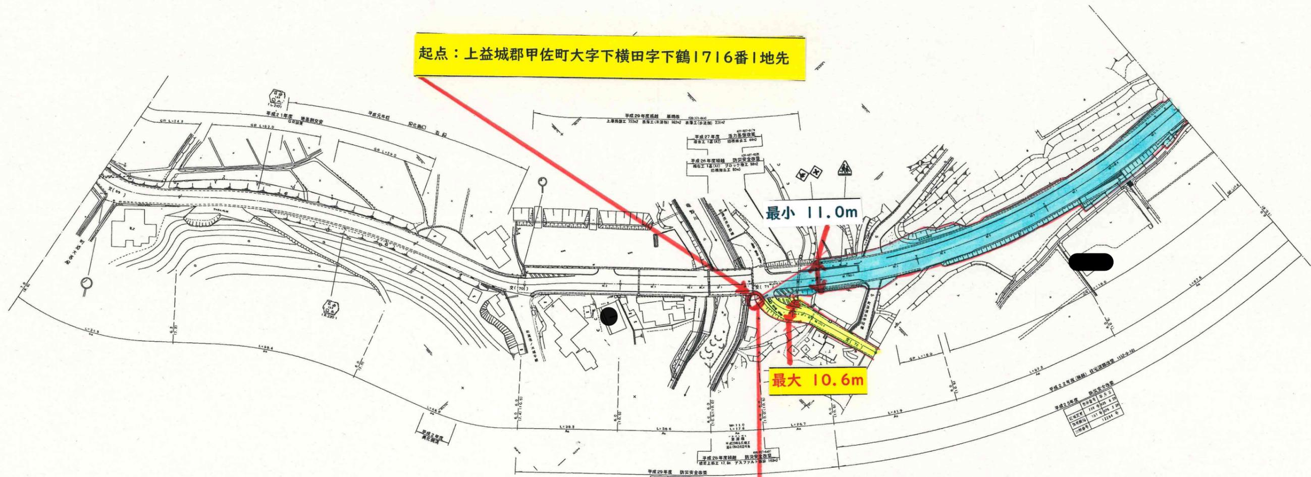
新 L=648.3m 最大幅=24.6m 最小幅=11.0m
