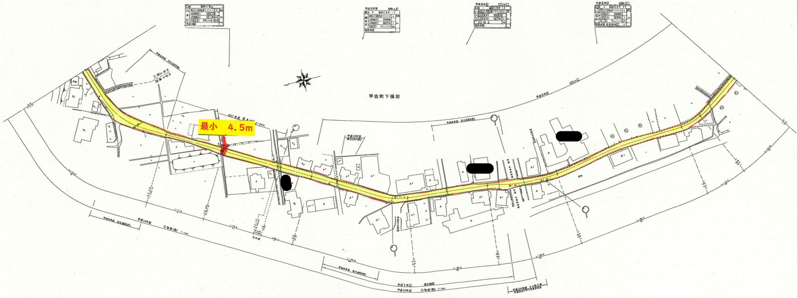
新 L=648.3m 最大幅=24.6m 最小幅=11.0m
