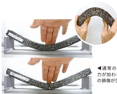
◀通常のアスファルトは力が加わるとひび割れ等の損傷が生じます。
