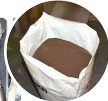
汚泥はローラーでプレス脱水、熱風乾燥の後に肥料になります。
