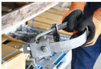
撤去後の金物(自社所有分)は使い回せる部品のみを選別して保管しておきます。
